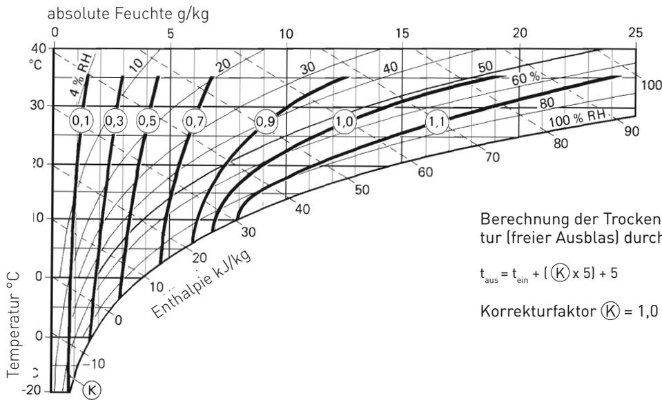
Berechnung der Trockenluft-Austrittstemperatur (freier Ausblas) durch folgende Formel:
