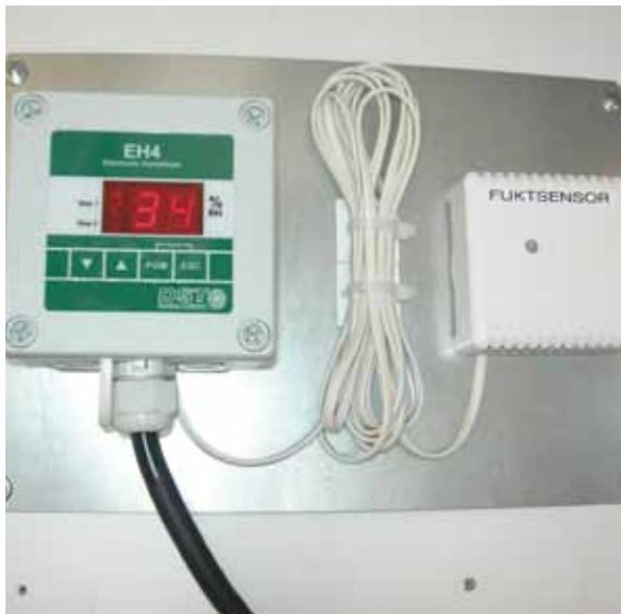
EH-4, elektronisk humidistat med snabb respons kapacitiv typ fukt sensor.
